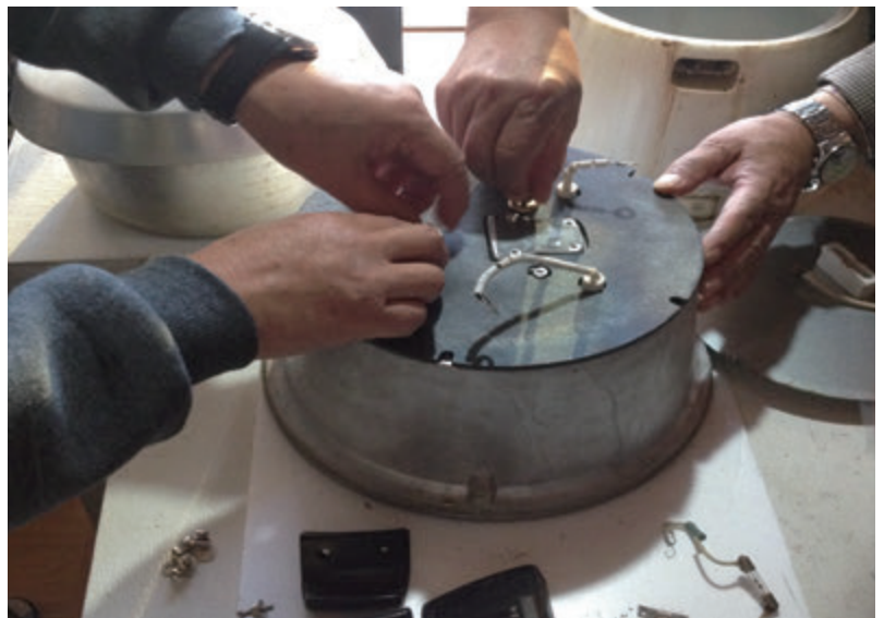
道具学会内の家電研究会の会合で、ごく初期の炊飯器、東芝ER-5（発売：1956年）を分解している
